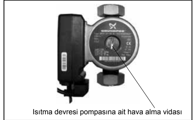
Resim: Isıtma devresi pompası ve boiler besleme pompasından hava alma
